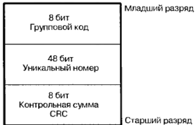
Рисунок 4.18 – Структура индивидуального кода микросхемы 1-Wire
